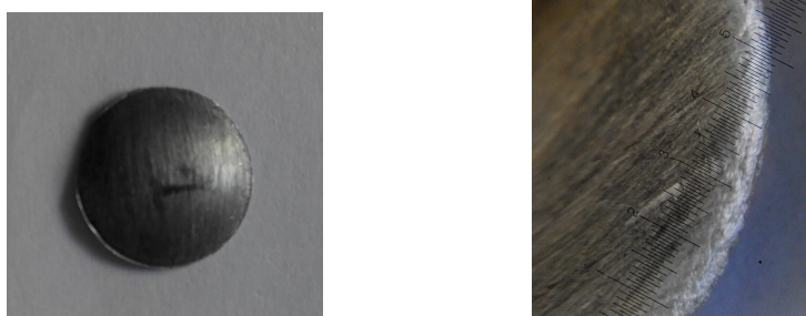
Рисунок 2 — Вид и качество среза отхода № 1 после пробивки (диаметр 15 мм, толщина материала 0,7 мм, угол заострения клиновидного ребра 45°)
