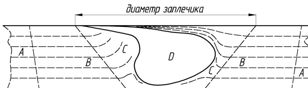
А — основной металл; В — зона термического влияния; С — зона термомеханического воздействия; D — зона перемешивания (ядро шва)
