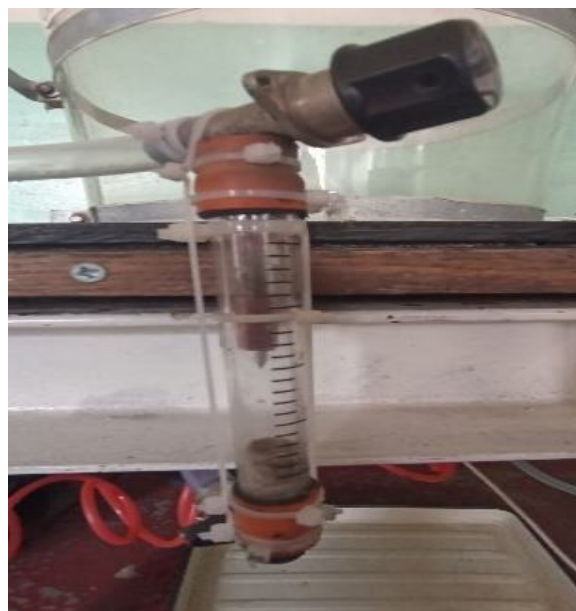
Рисунок 2 — Поплавковый расходомер газа РСМ-15
