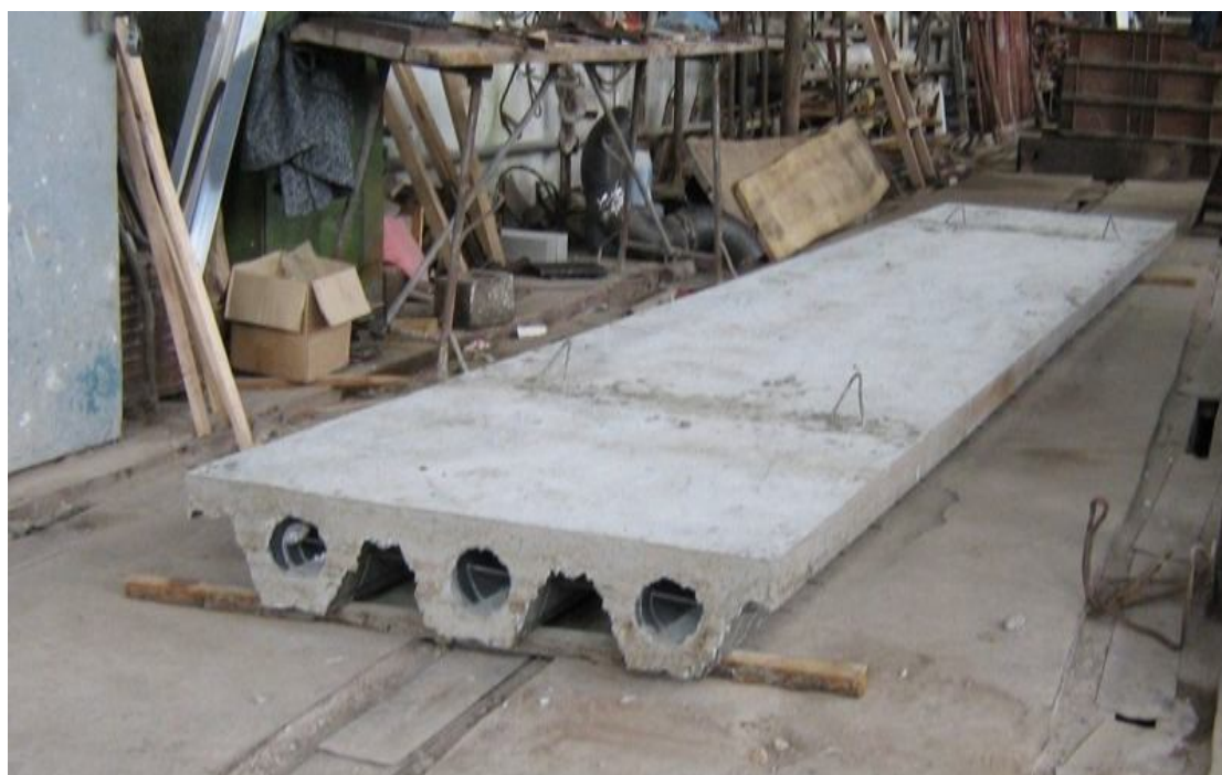
Рисунок 3 — Плита пролетом 6 м после изготовления и распалубки
