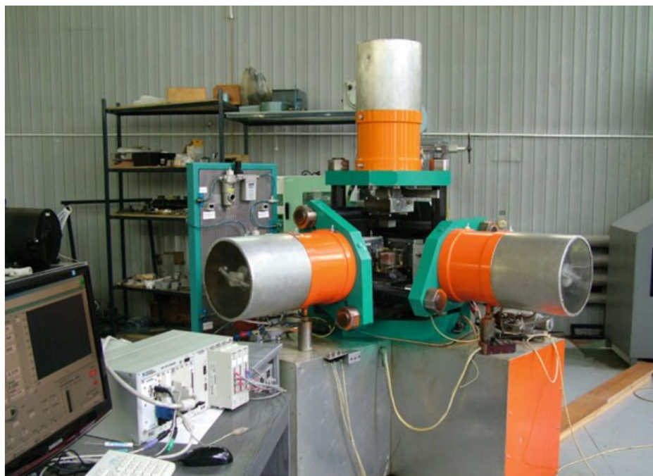
Рисунок 4 — Трехосная испытательная система для создания неравнокомпонентных нагрузок на образец (Triaxial independent loading test system — TILTS) 2
