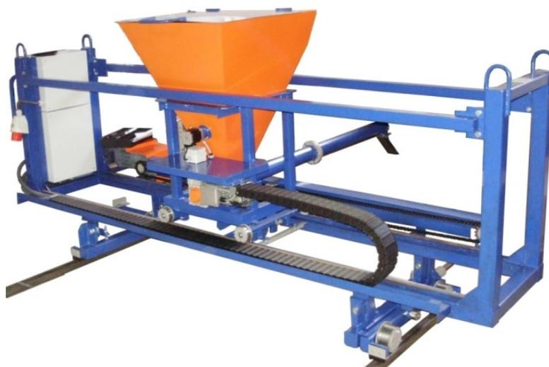
Рисунок 5 — Система механизированной подачи ШОС, размещаемая перед промежуточным ковшем МНЛЗ
