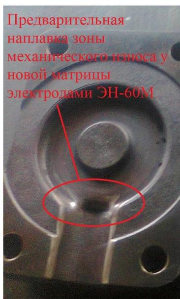
Рисунок 4 — Наплавленная электродами ЭН-60М формовочная матрица ГКМ
