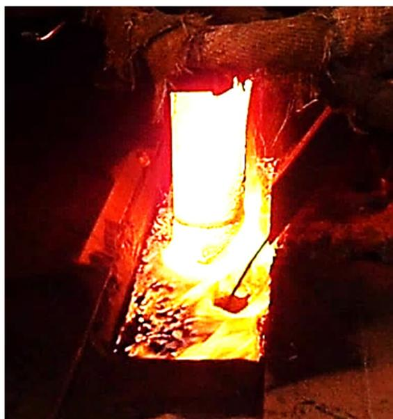
Рисунок 3 — Механизированная подача шлакообразующей смеси в кристаллизатор слябовой МНЛЗ
