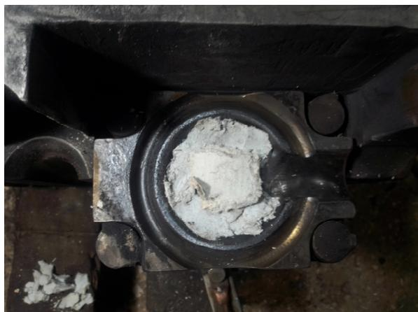
Рисунок 7 — Подготовка под наплавку
