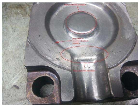
Рисунок 5 — Третья наплавка формовочной матрицы ГКМ электродами ОЗШ-3
