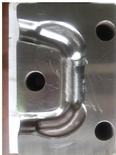
Рисунок 6 — Наплавка чеканочного штампа электродами ОЗШ-3
