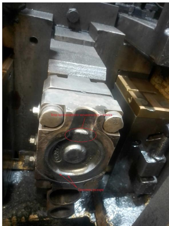
Рисунок 2 — Изношенная формовочная матрица на ГКМ
