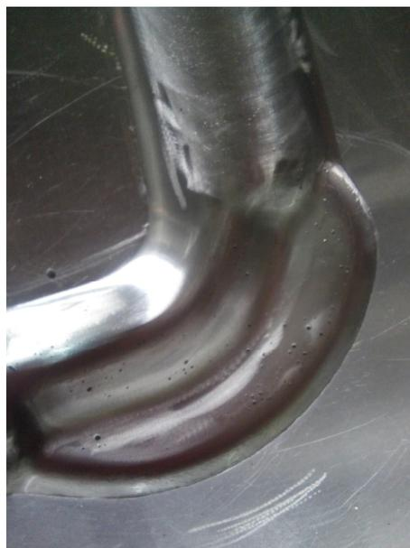
Рисунок 8 — Газовая пористость после наплавки ОЗШ-3
