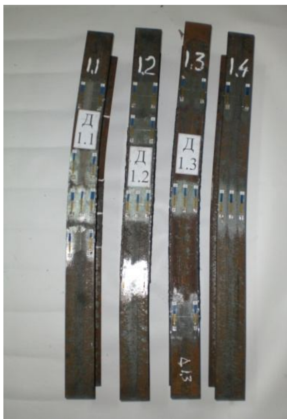
Рисунок 2 – Общий вид одной из серий прокатных образцов ([8, 9]) после испытаний
