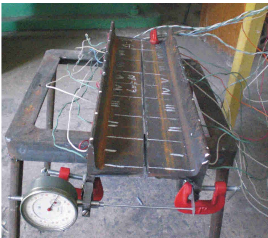
Рисунок 4 – Определение продольного остаточного напряженного состояния в образцах
