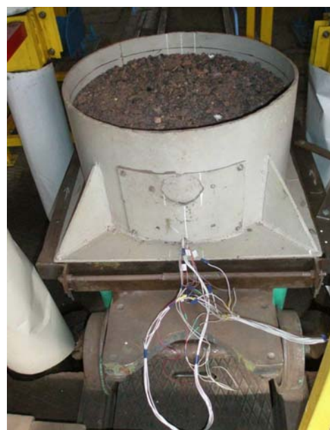
Рисунок 3 – Испытательная емкость, заполненная золой
