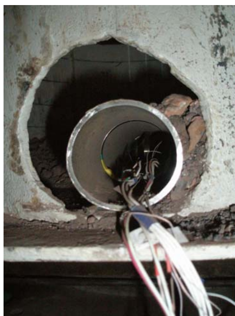
Рисунок 2 – Вид технологического отверстия с отрезком трубы и измерительной аппаратурой
