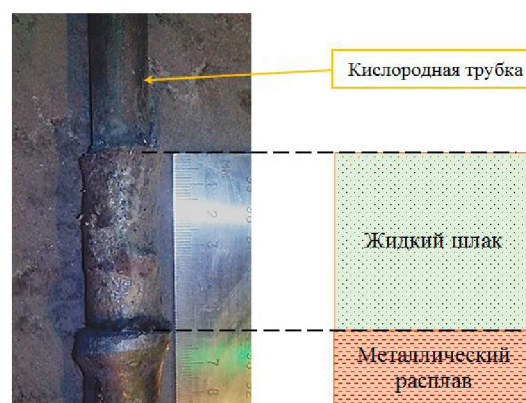
Рисунок Фото фрагмента кислородной трубки после погружения в расплав для определения толщины шлакового расплава в промежуточном ковше
