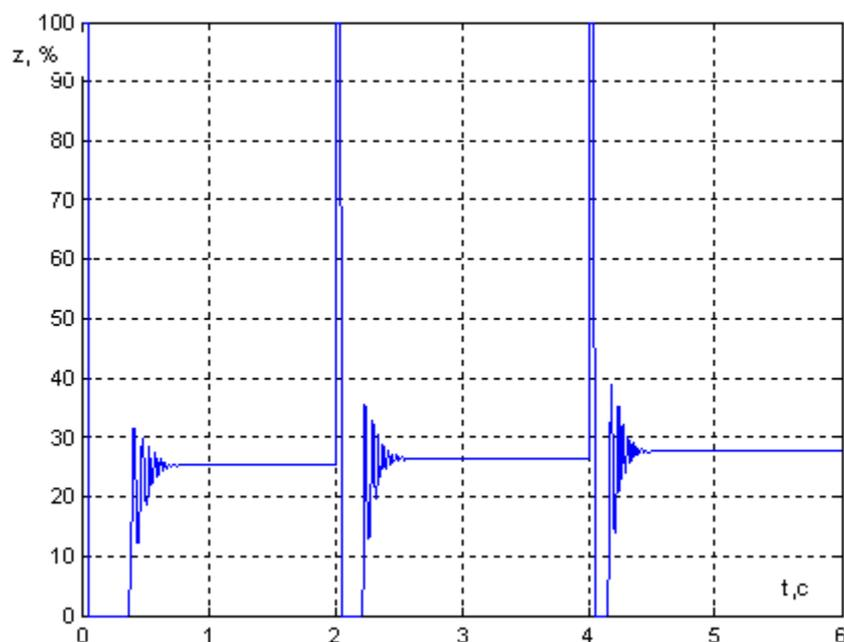
Рисунок 5 График переходного процесса по перемещению управляющего клапана при ступенчатом изменении скорости вращения
