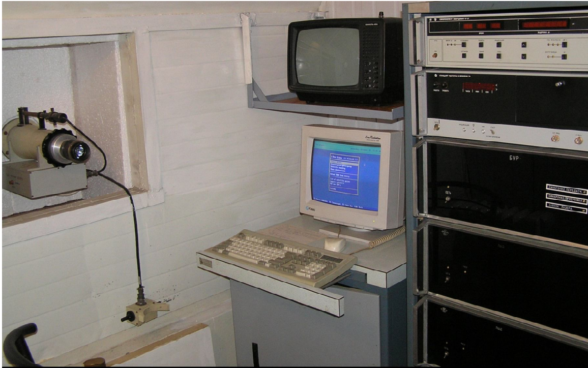
Рисунок 5 – Рабочее место оператора, устройства компьютерного управления телескопом и аппаратура для обработки и регистрации информации
