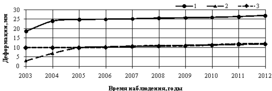
Рисунок 7 – График мониторинга за деформациями жилых домов по ул. К. Либкнехта, 57 (1), ул. К. Либкнехта, 54 (2), ул. К. Либкнехта, 50 (3), в г. Стаханов
