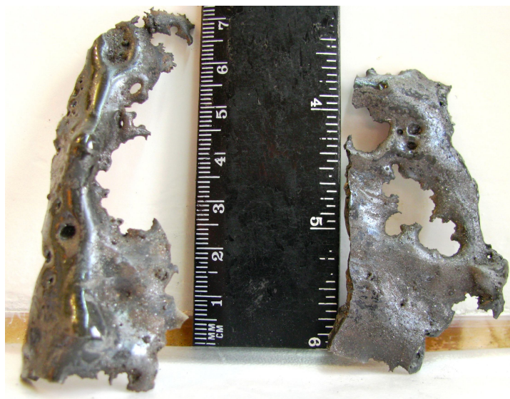
Рисунок 3 – Фрагменты шлаковой корки подменисковой зоны с нарушением целостности поверхности
