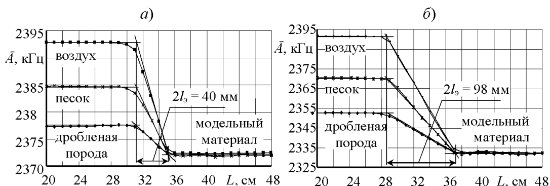
Рисунок 2 – Определение эффективной длины датчика по результатам тарировки интроскопа в различных средах при различных диаметрах шпура d_{ш} = 46 мм (а) и d_{ш} = 36 мм (б)
