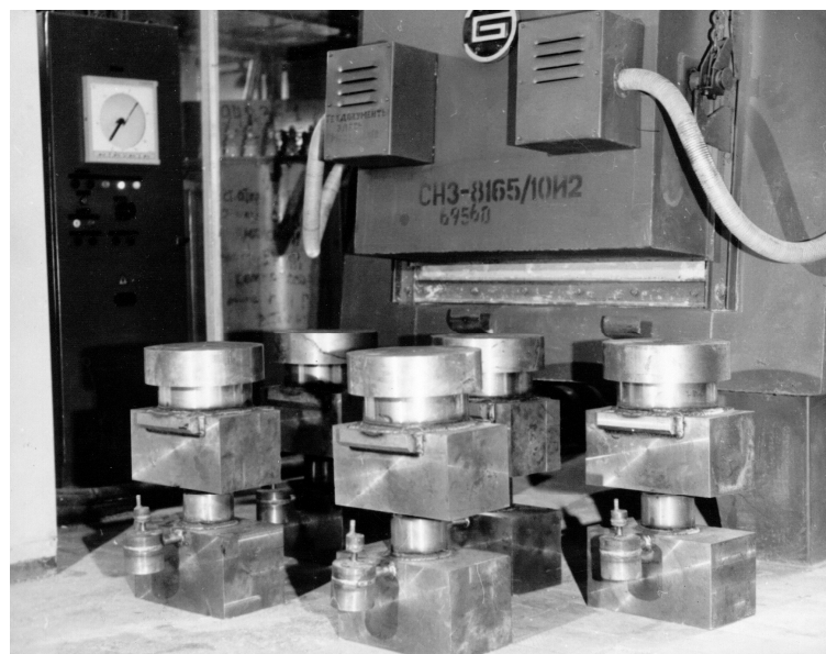
Рисунок 8 - Заготовки сталевих циліндрів компресорів, підготовлені для автовакуумного паяння
