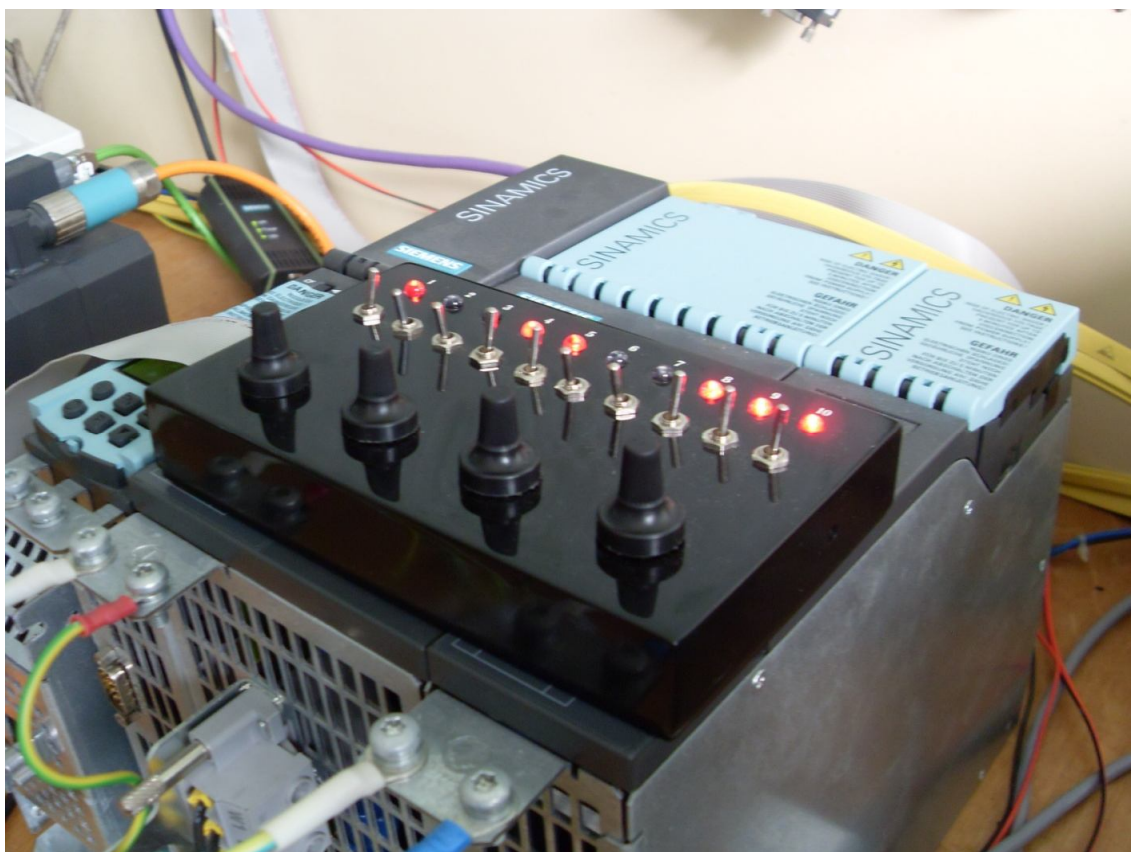
Рисунок 1 – Преобразователь Sinamics s120, входящий в состав созданной универсальной лабораторной установки
