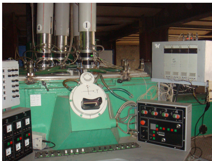
Рисунок 1 – Электронно-лучевая установка МВ-1: пульт управления и 4 электронные пушки
