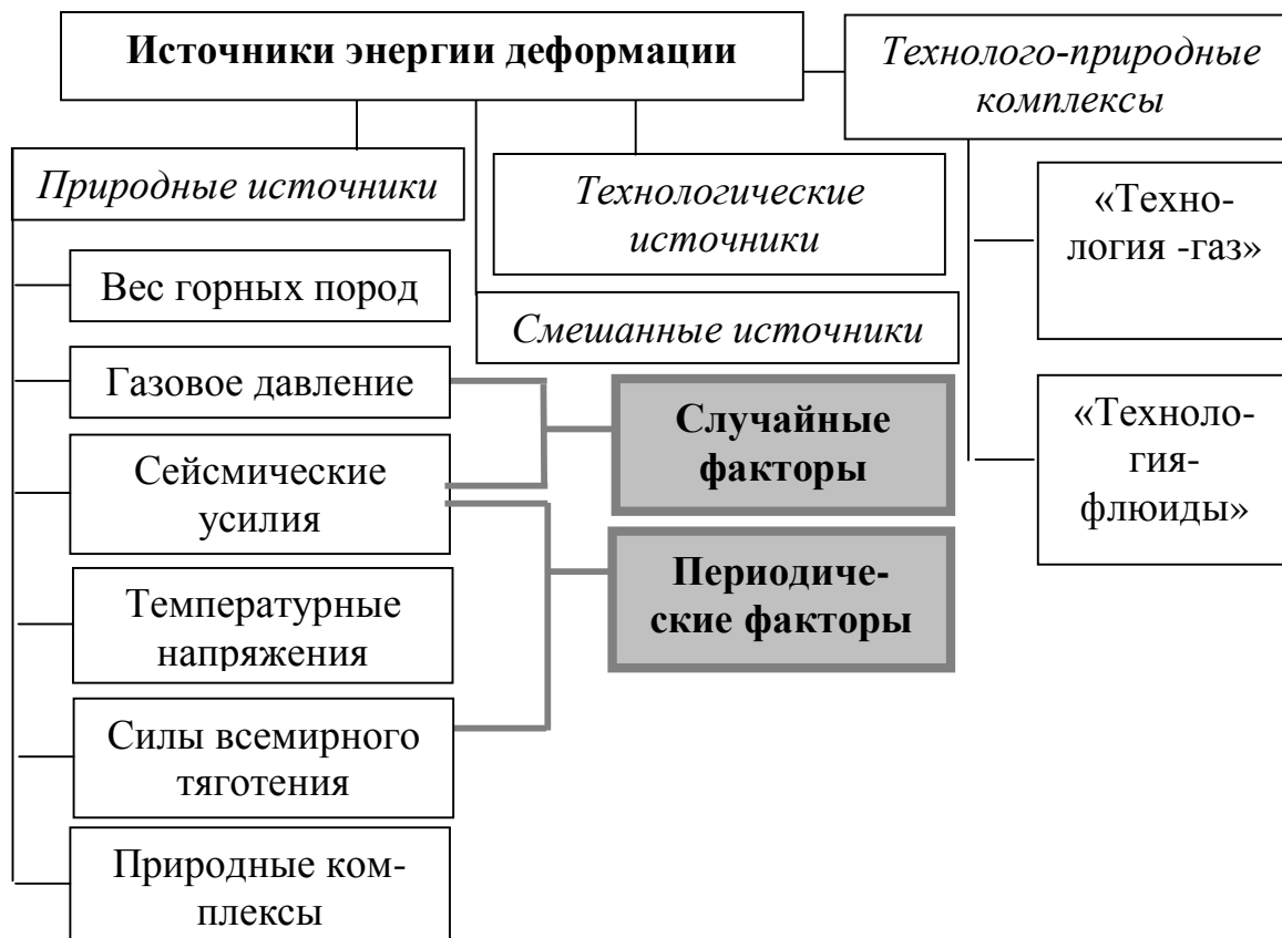
Рисунок 1 – Структурная схема факторов, вызывающих импульсные процессы
