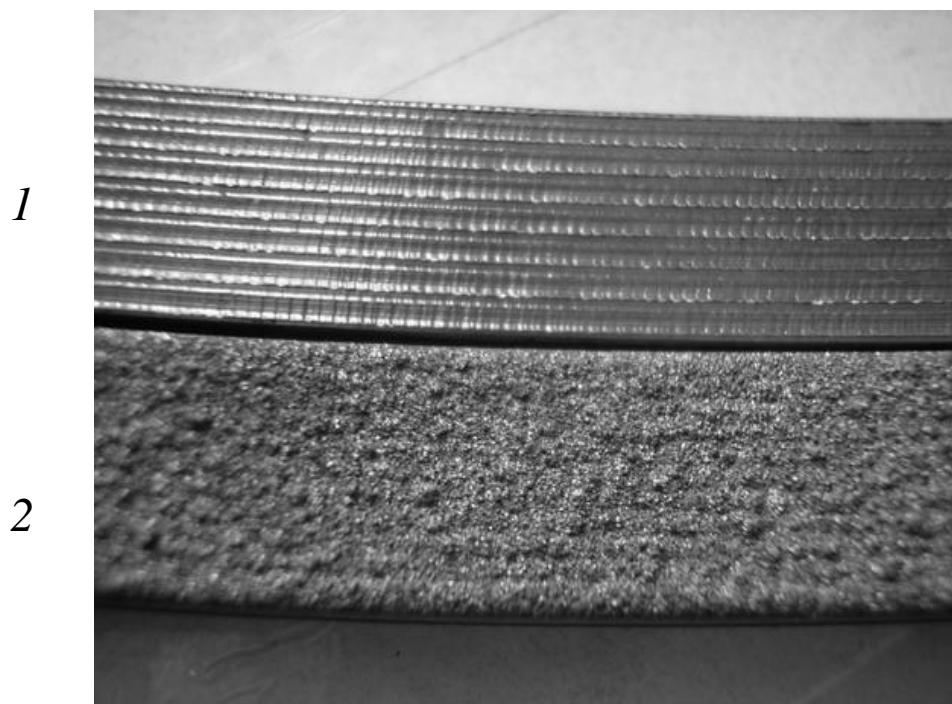
Рисунок 3 – Кольца рабочих колес вертолетного двигателя 1 – поверхность расточенного под напыление кольца; 2 – поверхность напыленного кольца
