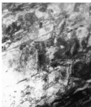
Рисунок 3 – Структура після загартування та холодної деформації \varepsilon \approx 68\% ; \times 20\,000
